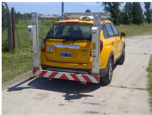
Figura 11: Perfilómetro Transversal Láser 3D de la DNV
