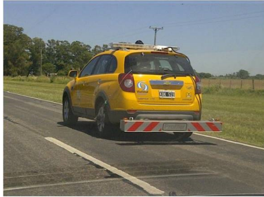
Figura 10: Perfilómetro MLPL en medición en ruta
