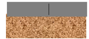
Pavimento de Hormigón Losas cortas + fibras
