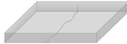
Grieta Transversal desde Abajo
