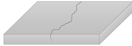
Grieta Transversal desde Arriba
