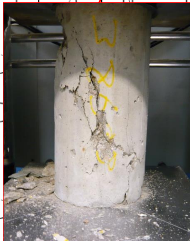
Fig. 4 – Ejemplos de roturas no satisfactorias en probetas cilíndricas
