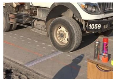
Figura 46: Aplicación de carga móvil, tramo 1.
