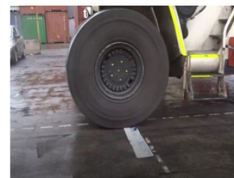
Figura 47: Aplicación de carga móvil, tramo 2
