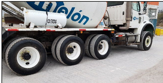
Figura 43: Configuración de ejes y ruedas camión mezclador.
