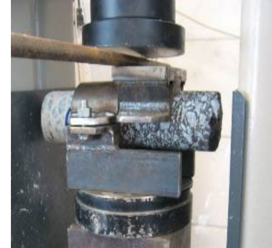
Adherencia HRF-Asfalto (corte)
