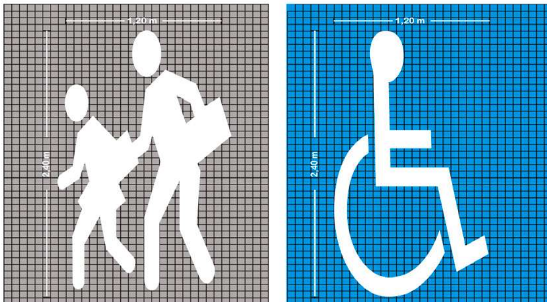
Figura 3.20 Símbolos sobre el pavimento
