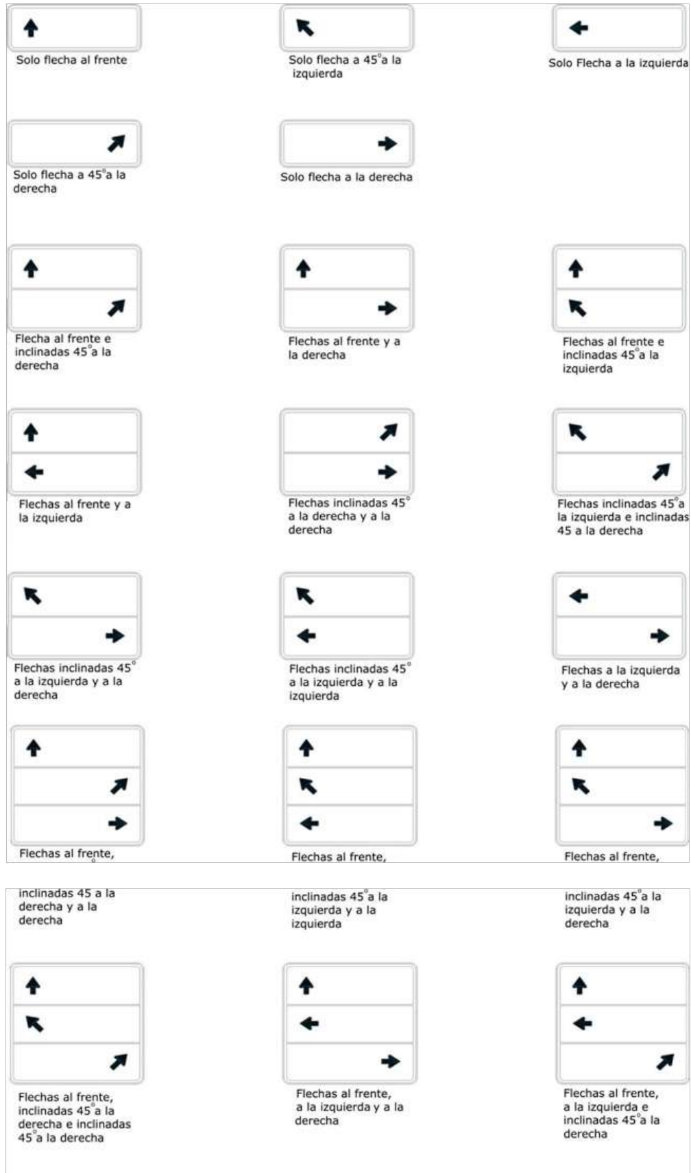
Figura 3.3.2_17. DISPOSICIÓN DE FLECHAS EN SEÑALES INFORMATIVAS LATERALES
