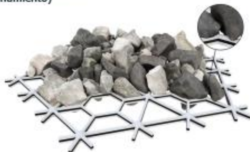
Restricción lateral y trabazón con el agregado (Confinamiento)
