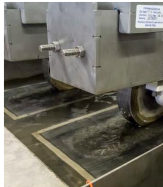
Ensayo de Rueda de Hamburgo
