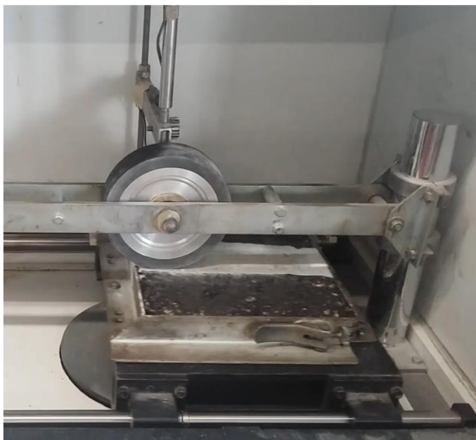
Evaluación de la Resistencia al Ahuellamiento
