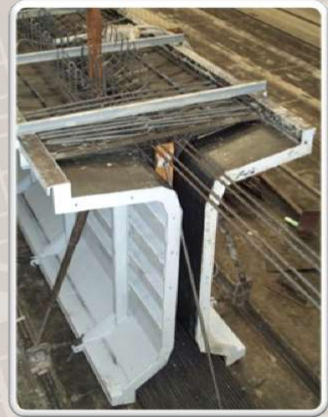
Vigas pretensadas, hormigonadas en planta
