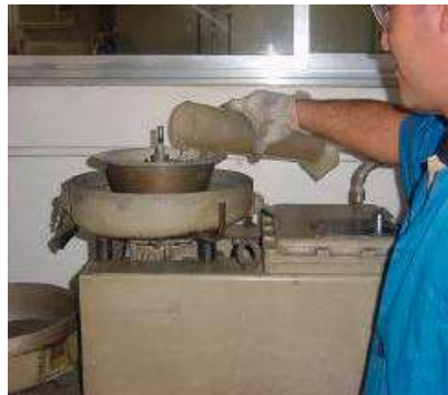
Figura 11 Adición del solvente (Xileno) a la muestra
