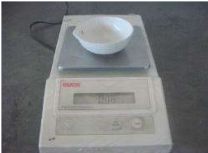
Figura 19 Pesada del crisol
