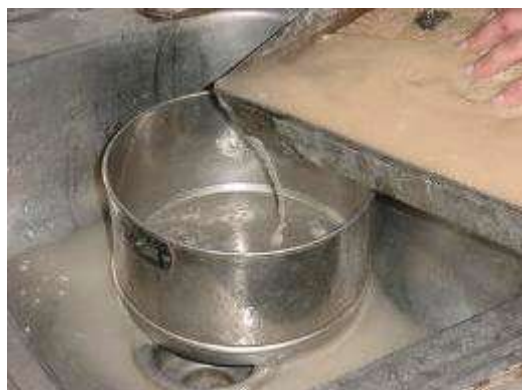
Figura 12 Eliminación del exceso de agua de la muestra saturada
