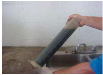
Figura 21 Agitación de la probeta con la alícuota extraída
