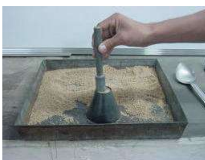
Figura 15 Compactación del material
