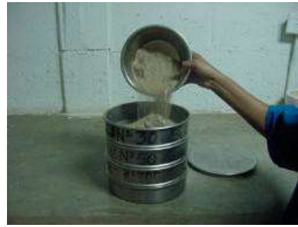
Figura 6 Vaciado de los tamices
