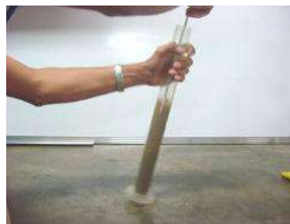
Figura 16 Introducción del tubo irrigador al fondo de la probeta
