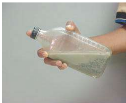
Figura 5 Agitación de muestra con el NaOH
