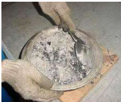
Figura 10 Mezcla de los agregados y C.A.
