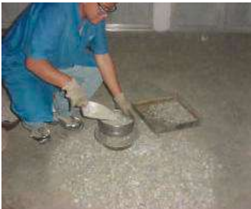
Figura 5 Tamizado de los agregados
