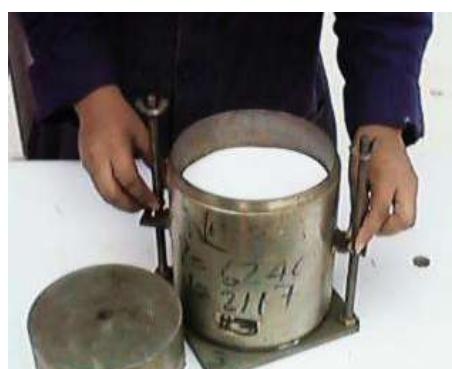
Figura 6.1_107. Inversión del Molde
