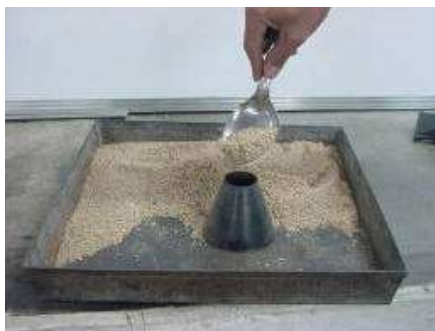
Figura 14 Adición del material en el molde cónico estándar
