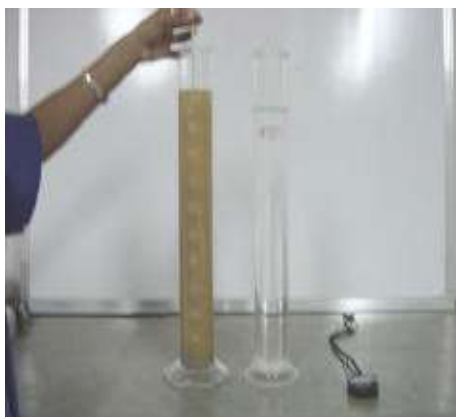
Inmersión del Hidrómetro en la Sedimentación
