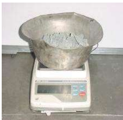
Figura 9 Peso de partículas alargadas y aplanadas
