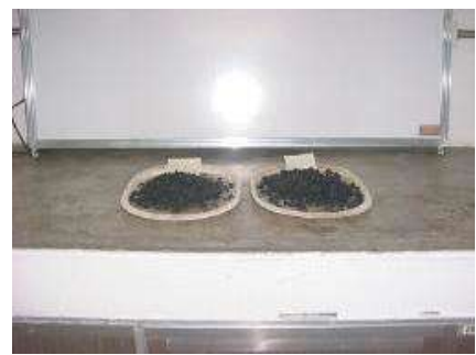
Figura 11 Fracción gruesa y fina tamizadas
