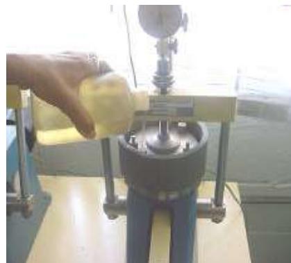
Figura 6.1_129. Inundación de carga
