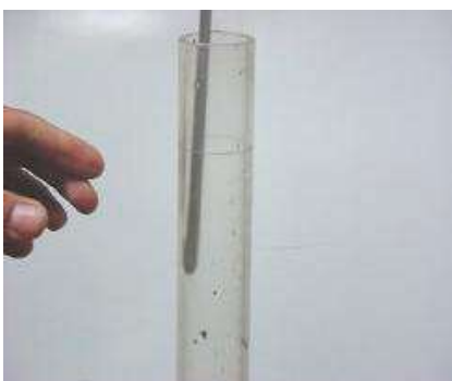
Figura 15 Lavado de las paredes de la probeta
