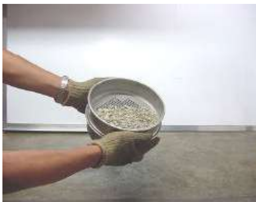
Figura 6.1_63. Tamizado de la muestra en Tamiz N°4
