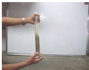
Figura 6.1_68. Expulsión de las burbujas de aire en la probeta de ensayo
