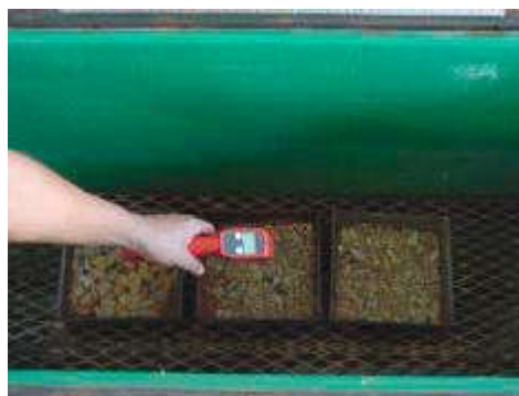
Figura 6 Verificación de temperatura de ensayo
