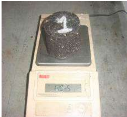
Figura 19 Peso en el aire de la briqueta
