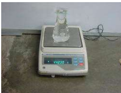
Figura 11 Peso del frasco + agua a capacidad total
