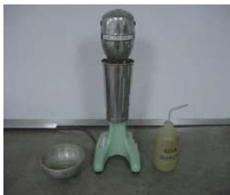
Colocación del Vaso en el Agitador Eléctrico
