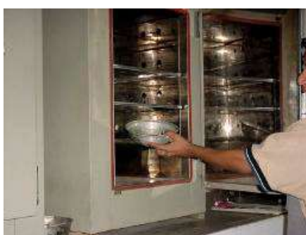
Figura 9 Secado de muestra
