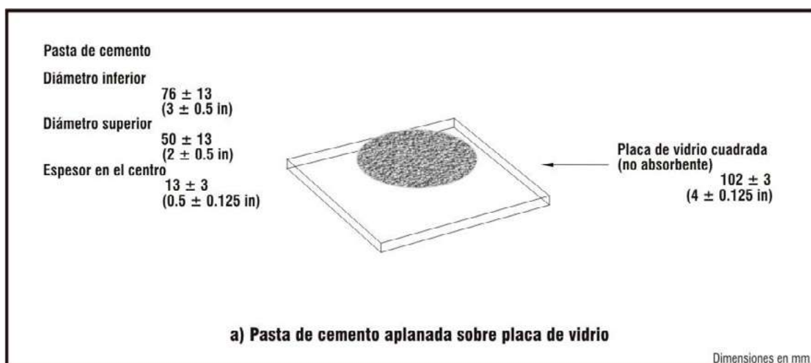
Figura 6.3_18. HORMIGÓN SOBRE PLACA DE VIDRIO
