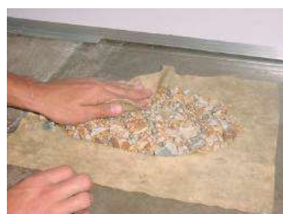
Figura 14 Muestra en Superficie Seca Saturada s.s.s.
