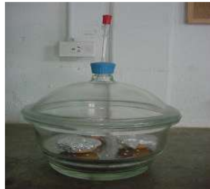
Figura 6.1_84. Muestra en el Desecador
