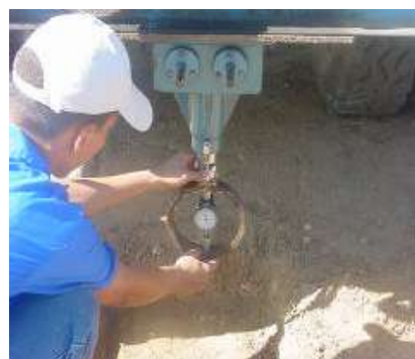
Figura 6.1_201. Instalación del anillo de carga
