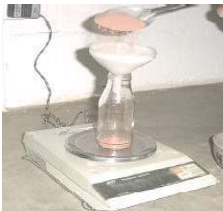
Figura 6.1_57. Adición de la Muestra al Envase
