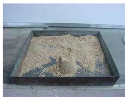
Figura 16 Forma del material sin el cono estándar
