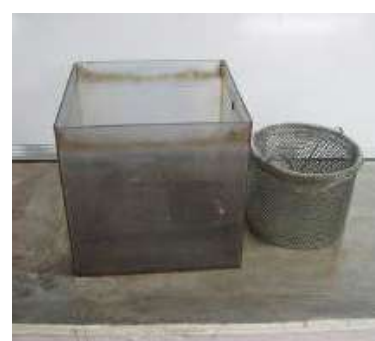
Figura 11 Cesta a ser sumergida con la muestra en agua
