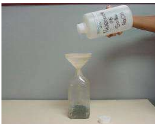
Figura 4 Adición de NaOH a la muestra
