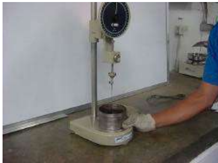
Figura 9 Colocación del Cemento Asfáltico en el penetrómetro
