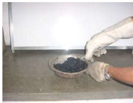
Figura Mezclado del Cemento asfáltico con los agregados
