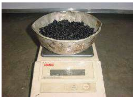
Figura 7 Peso del material cuarteado
