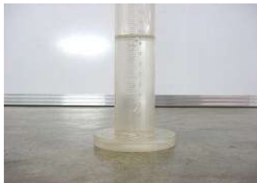
Figura 6.1_66. Llenado de la probeta con la solución de ensayo
