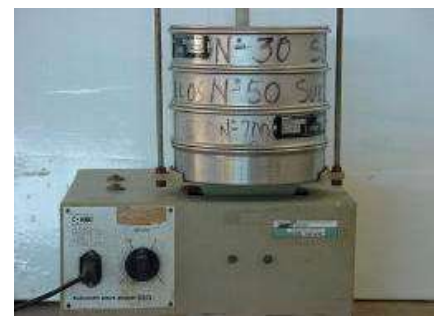
Figura 11 Tamizado eléctrico de la muestra
