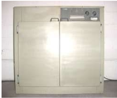
Figura 6.1_64. Horno utilizado en el ensayo
