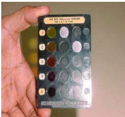
Figura 8 Comparación de la coloración de la muestra con la Tabla Gardner
