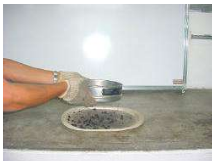
Figura 10 Tamizado de la muestra
