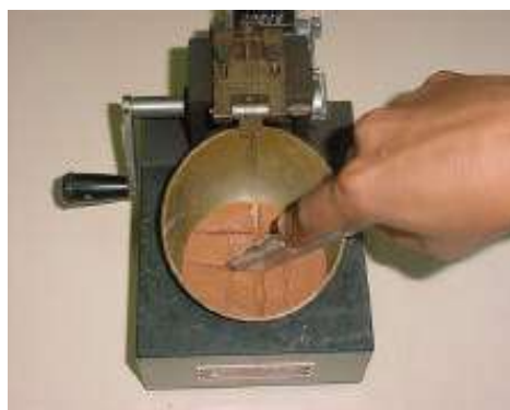
Figura 6.1_25. Corte y Retiro del Material
