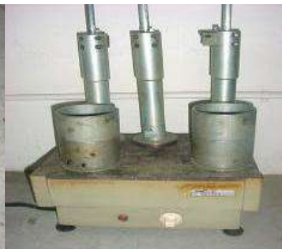
Figura 11 Calentamiento del equipo para compactar la mezcla
