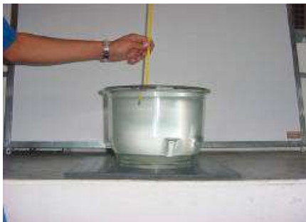
Figura 3 Pesada del frasco vacío
