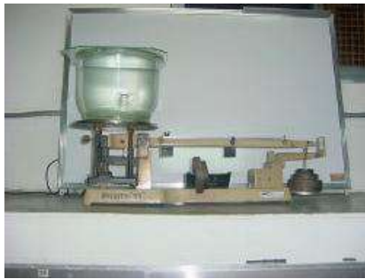
Figura 5 Pesada del frasco enrasado con agua
