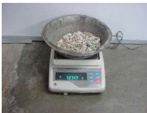
Figura 19 Peso de la muestra seca
