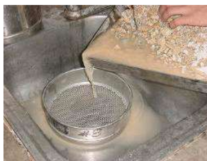
Figura 7 Lavado de la muestra
