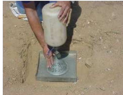
Figura 6.1_204. Determinación de la humedad y peso unitario
