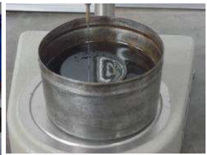
Figura 10 Contacto de la aguja del penetrómetro con la superficie del Cemento Asfáltico
