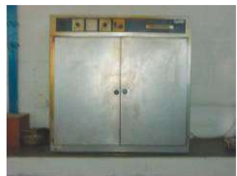
Figura 4 Horno para ensayo Marshall
