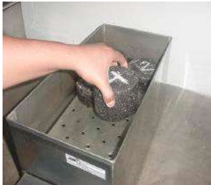
Figura 22 Briquetas en baño de María
