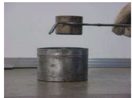
Figura 7 Colocación del Cemento Asfáltico en recipiente con agua
