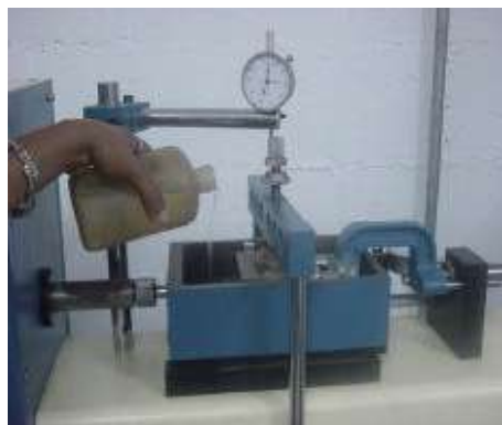
Figura 6.1_155. Saturación de Muestra con Agua
