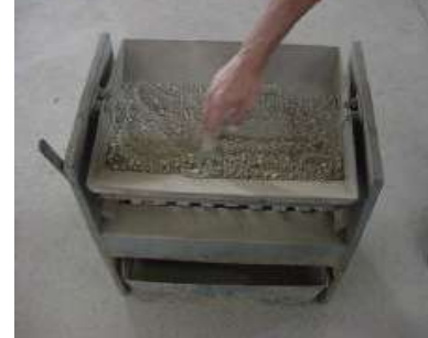
Distribución Uniforme de la Muestra
