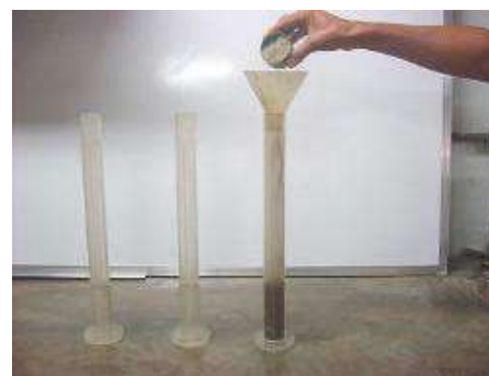
Figura 10 Adición del agregado en la probeta de ensayo
