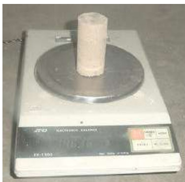
Figura 6.1_141. Pesada de la muestra
