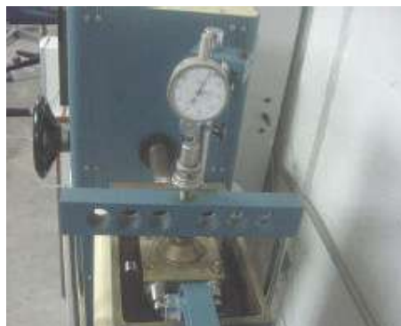
Figura 6.1_154. Colocación de Puente de Carga sobre la Muestra
