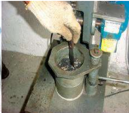
Figura 14 Punción de la muestra
