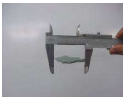
Figura 7 Medición del largo de la partícula
