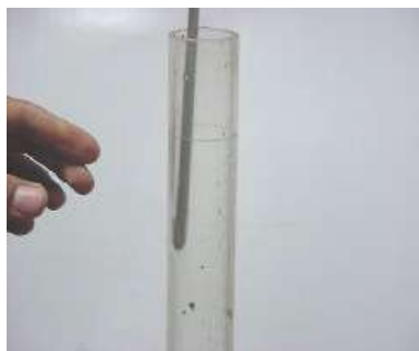
Figura 6.1_72. Lavado de las paredes de la probeta
