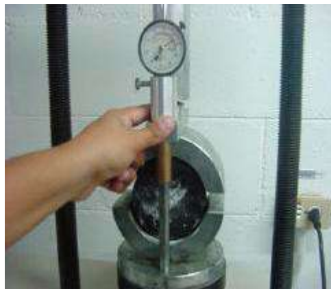
Figura 25 Sujeción del medidor de deformación
