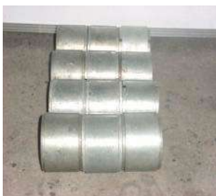
Figura 16 Briquetas en reposo en los moldes
