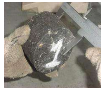
Figura 18 Medición de las briquetas
