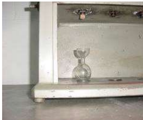
Figura 3 Tapón de corcho obstruyendo la salida del fluido
