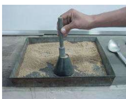
Figura 15 Compactación del material
