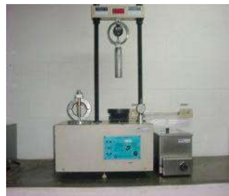
Figura 2 Equipo de compactación y extractor de muestras
