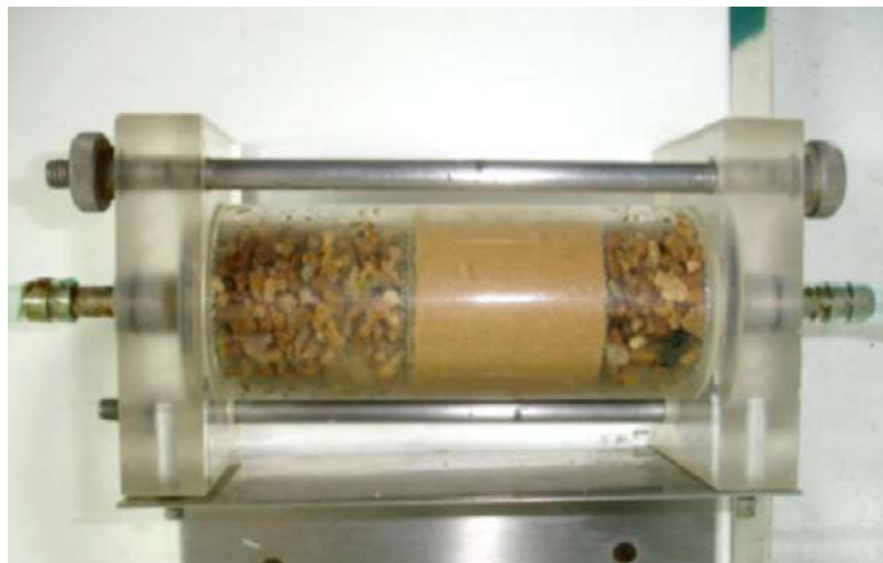
Figura 6.1_218. Esquema del montaje general del Ensayo Pinhole.
