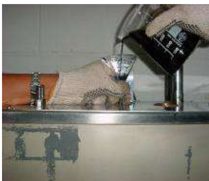
Figura 4 Adición de muestra al viscosímetro
