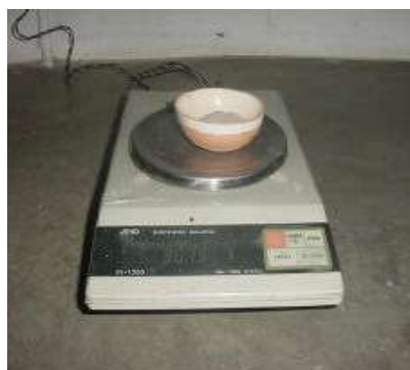
Figura 6.1_85. Muestra Seca pesada en el Crisol
