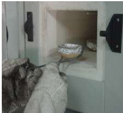
Figura 6.1_83. Extracción de la Muestra de la Mufla
