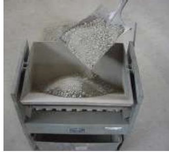
Muestra Agregada al Cuarteador
