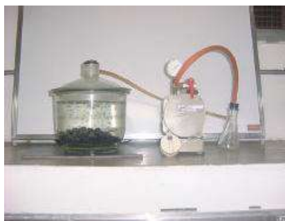
Figura 15 Extracción de los vacíos de la mezcla
