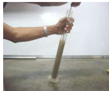
Figura 6.1_73. Introducción del tubo de irrigación al fondo de la probeta
