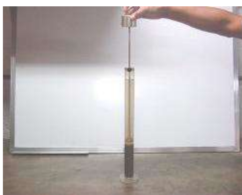
Figura 19 Barra estándar dentro de la probeta
