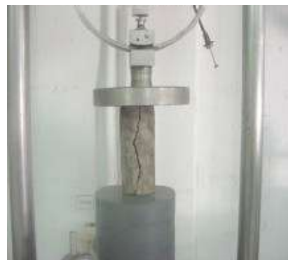
Figura 6.1_145. Probeta deformada (ocurrencia de falla)
