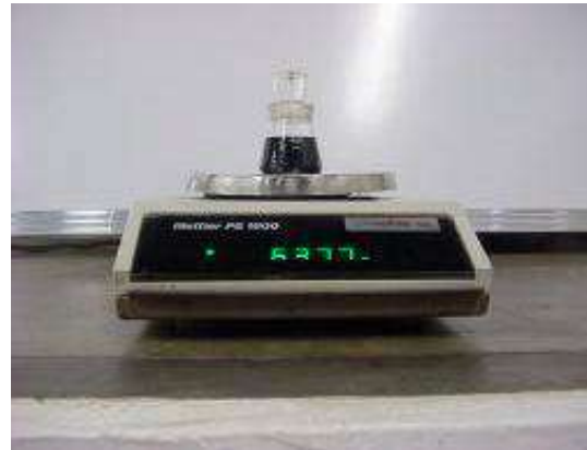
Figura 6 Pesada del picnómetro con el cemento asfáltico
