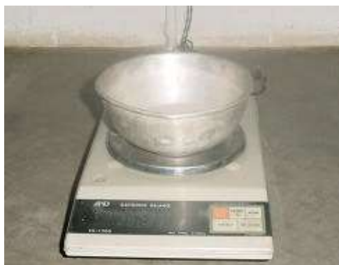
Figura 6.1_11. Pesado de la Muestra Secada al Horno
