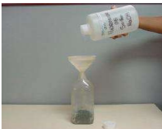
Figura 4 Adición de NaOH a la muestra
