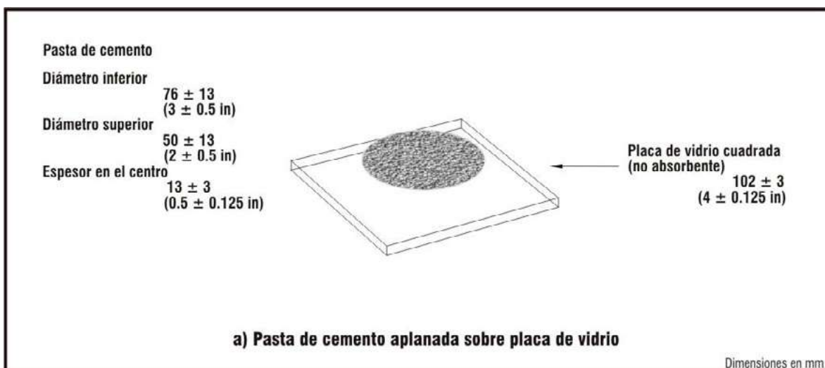
Figura 6.3_18. HORMIGÓN SOBRE PLACA DE VIDRIO
