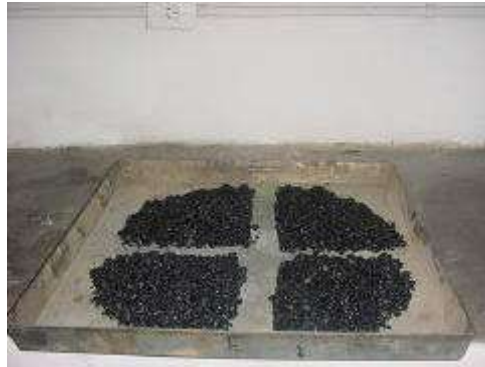
Figura 6 Cuarteo de la muestra de concreto asfáltico
