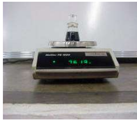
Figura 8 Peso del picnómetro después del reposo
