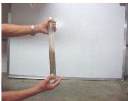
Figura 11 Expulsión de las burbujas de aire de la probeta
