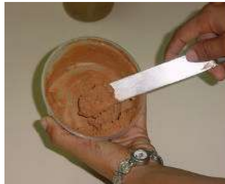
Figura 6.1_32. Muestra Plástica para Moldeo
