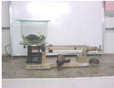
Figura 13 Pesada del frasco, el vidrio y la muestra
