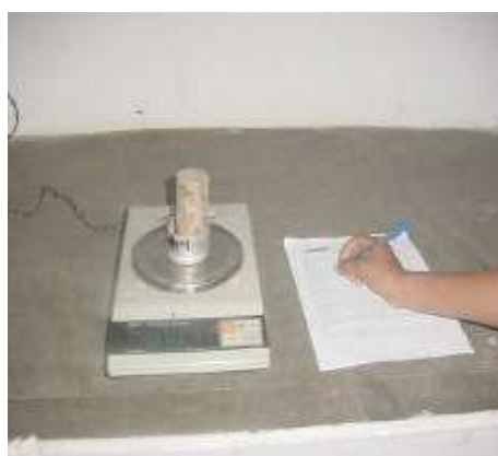
Figura 6.1_147. Pesada de la Muestra Ensayada
