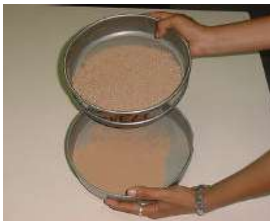
Figura 6.1_30. Material pasante por el Tamiz N° 40
