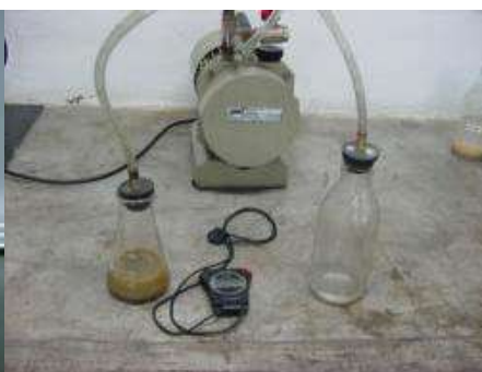
Figura 21 Frasco conectado a la bomba de vacío
