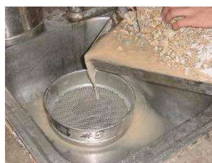
Figura 5 Lavado de la muestra
