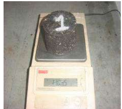
Figura 21 Peso de la briqueta saturada
