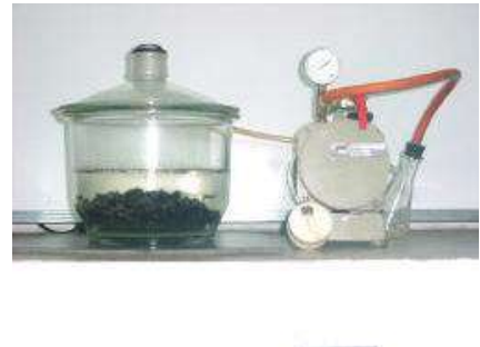
Figura 14 Extracción de los vacíos de la mezcla
