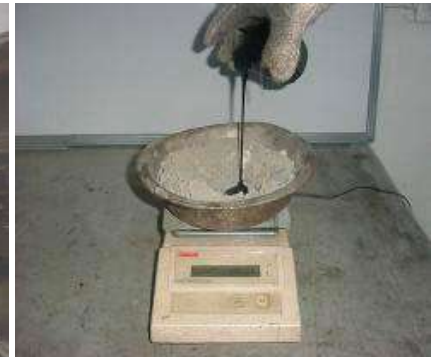
Figura 9 Adición del C.A. a los agregados
