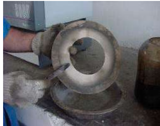
Figura 15 Limpieza del filtro
