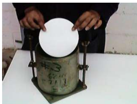
Figura 6.1_103. Colocación del Papel de Filtro
