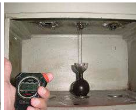
Figura 6 Medición el tiempo de caída del fluido
