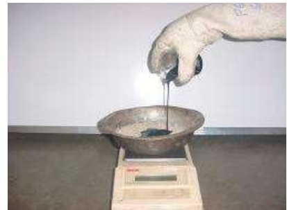
Figura 7 Adición del cemento asfáltico a la pesada
