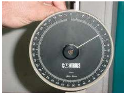
Figura 11 Lectura de ensayo de penetración
