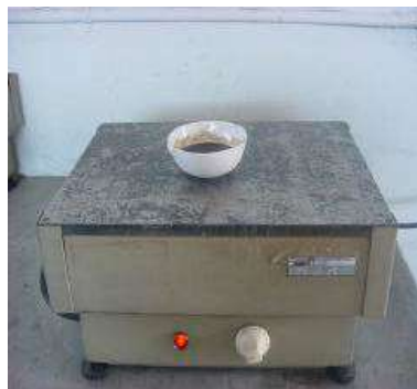
Figura 23 Colocación de la muestra en un plato caliente
