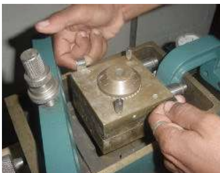
Figura 6.1_153. Instalación de la Caja de Corte
