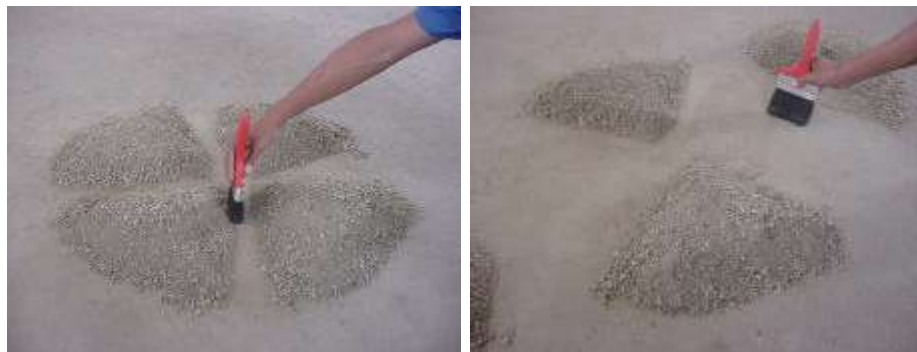
Separación de la Muestra en 4 Partes
