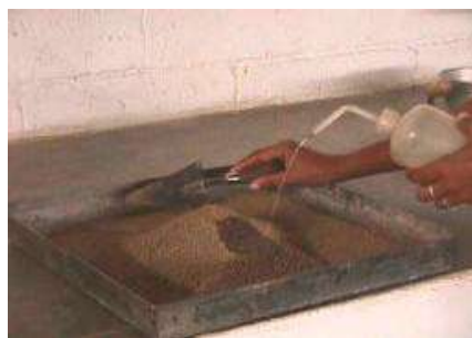
Figura 5 Rociado y mezclado del material
