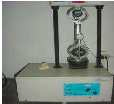
Figura 23 Colocación de la briqueta en la prensa Marshall
