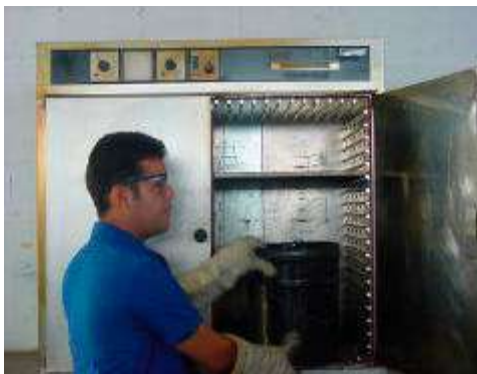
Figura 2 Colocación de la muestra en el horno
