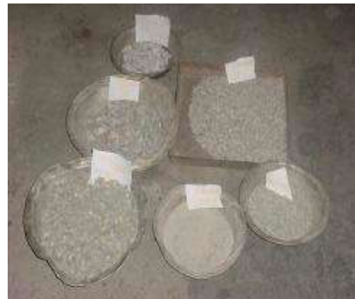
Figura 6 Agregados separados por los diferentes tamices
