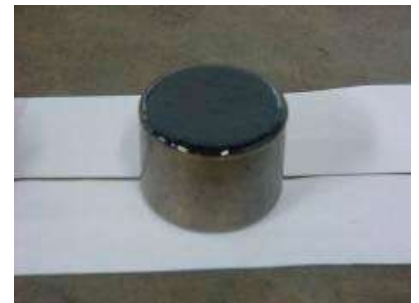
Figura 4 Recipiente con Cemento Asfáltico
