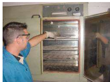
Figura 8 Colocación del filtro en el horn
