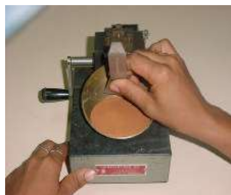
Figura 6.1_23. Ranuración de la Muestra
