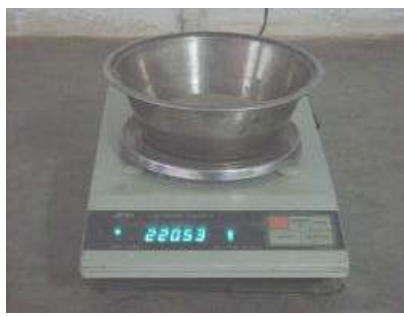
Figura 10 Pesada final del material
