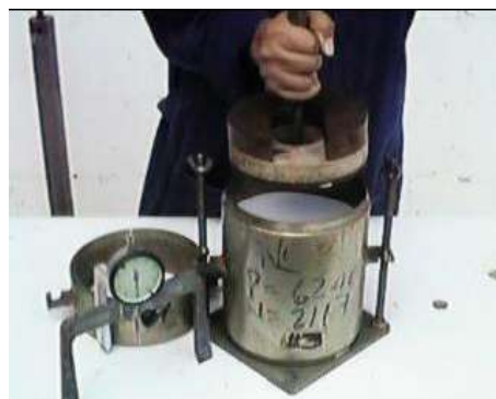
Figura 6.1_108. Colocación de Disco de Perforación
