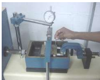
Figura 6.1_158. Separación de los marcos de corte
