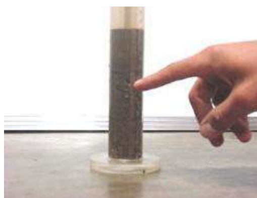
Figura 20 Lectura del Sedimento de arena
