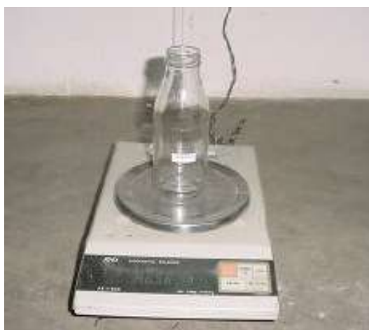
Figura 6.1_56. Pesada del Envase
