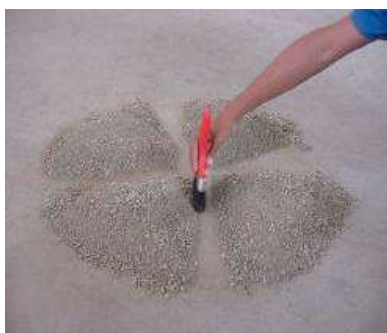
Figura 3 Cuarteo de muestra
