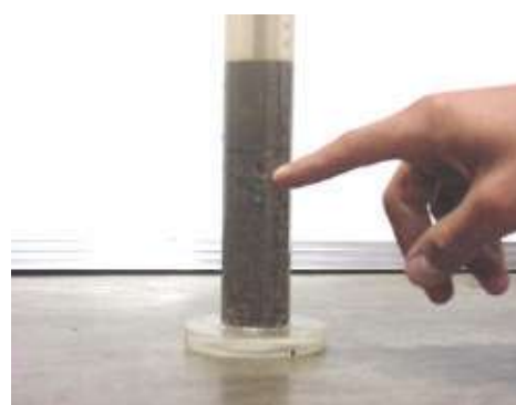
Figura 6.1_77. Lectura del sedimento de arena
