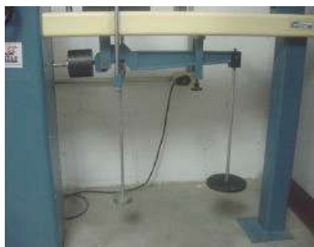
Figura 6.1_156. Colocación de carga en muestra
