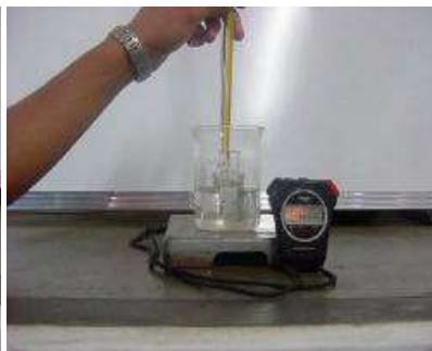
Figura 3 Picnómetro sumergido en agua
