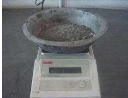
Figura 28 Peso de la muestra seca
