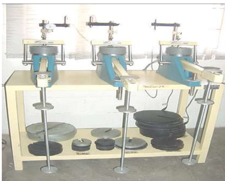
Figura 6.1_127. Equipo de Consolidación
