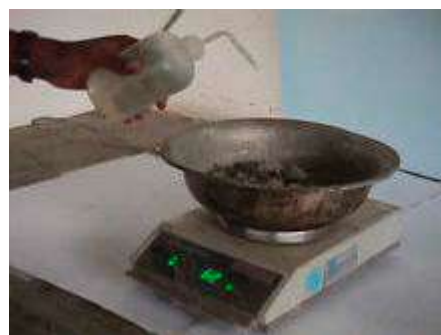
Figura 5 Añadiendo el agua de pre-mezcla
