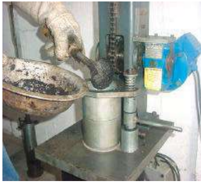
Figura 13 Colocación de la mezcla dentro del molde Marshall
