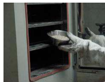
Figura 4 Introducción de la muestra en el horno
