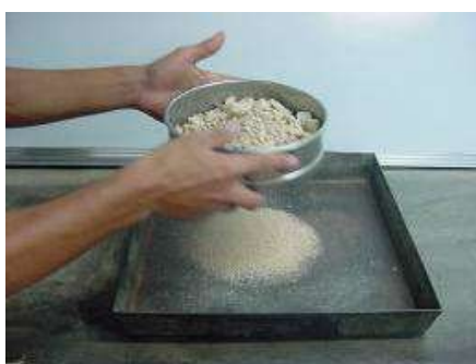
Figura 3 Tamizado de la muestra (tamiz N° 8)
