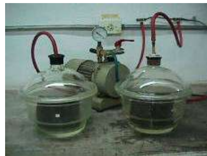
Figura 12 Briquetas sometidas a Inmersión y Vacío Parcial
