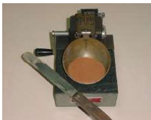
Figura 6.1_22. Material colocado uniformemente
