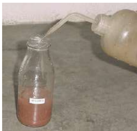
Figura 6.1_58. Adición de Agua Destilada al Envase
