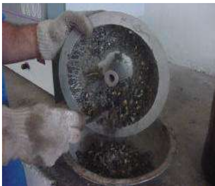
Figura 16 Colocación de la muestra ensaya en tara
